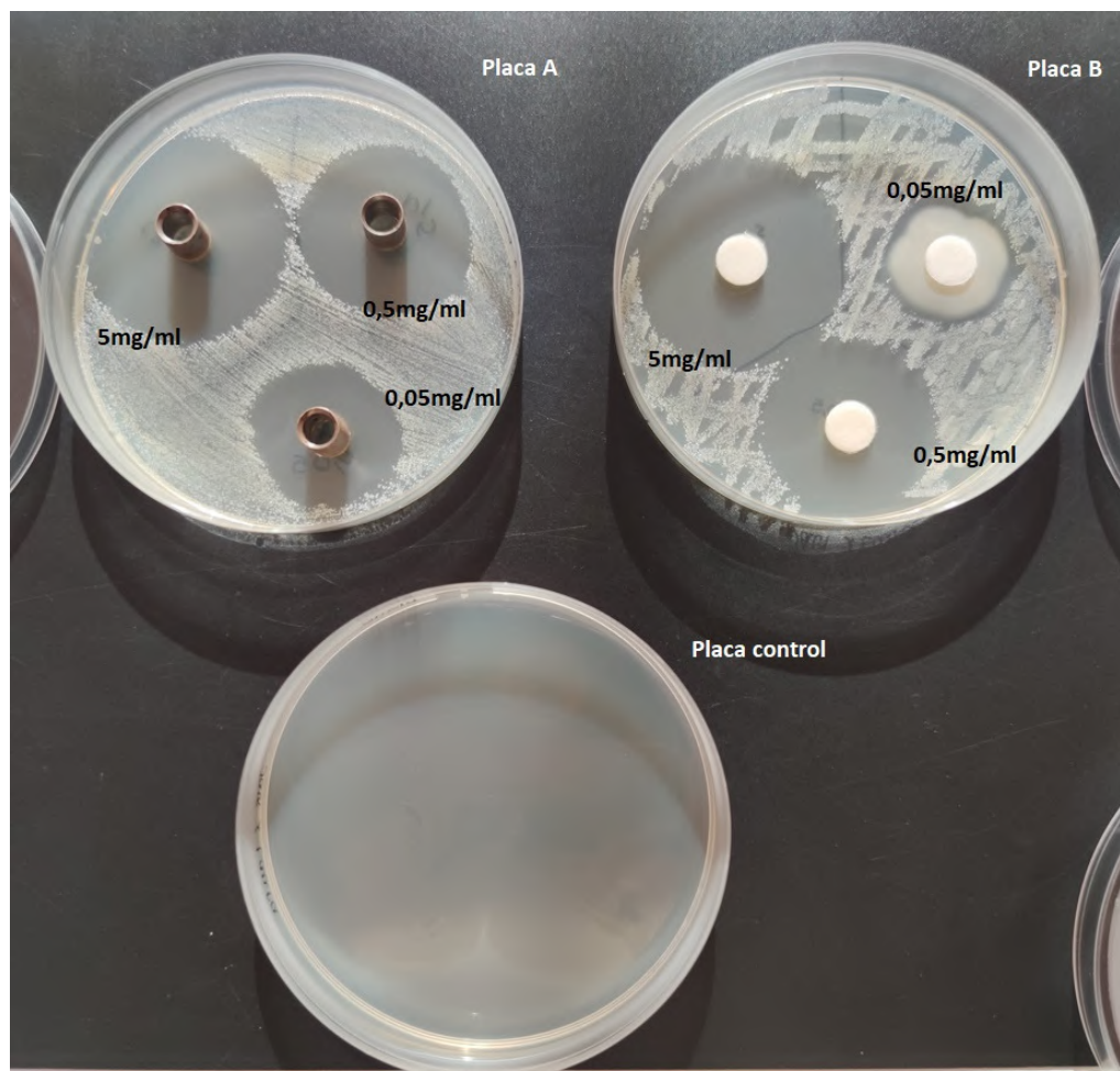
Figura 1: Placa A. Aplicació de l'antibiòtic amb torretes Oxford. Placa B. Aplicació de l'antibiòtic amb disc. Placa control. Medi utilitzat: PCA. Sembra en gespa amb una colònia blanca i cremosa. Incubació a 37°C durant 24h.
